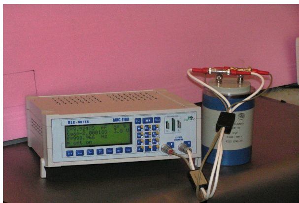
Рис.6 Прецизионный RLC метр МНС 1100 ООО «КПФ «ПРОМИКС»
