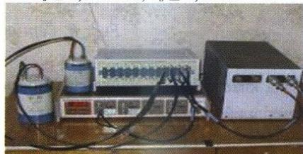
Багатоканальний компаратор емності «Султан»
